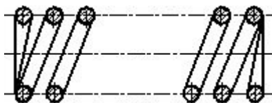
Рисунок 5 - Продольный разрез пружины
