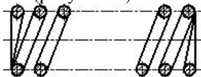
Рисунок 5 - Продольный разрез пружины
